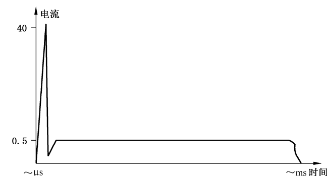
图 B.3 由两个幅值和持续时间不相同的放电电流组成的一个假定的决定性工况
